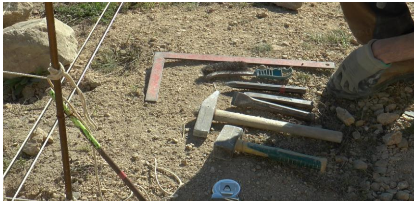
Figure 20 : La panoplie des outils du murailler. Crédit : PNRGM (2022)
