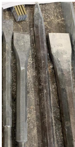
Figure 24 : Les outils de taille, de droite à gauche, la chasse, la pointerolle, et deux ciseaux de taille différente. Crédit : PNRGM (2022)
