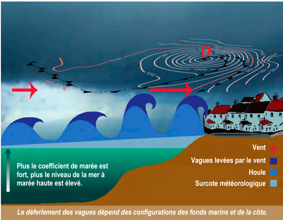
Figure C1 – Représentation schématique des différents processus engendrant le phénomène de submersion marine au passage d'une tempête
