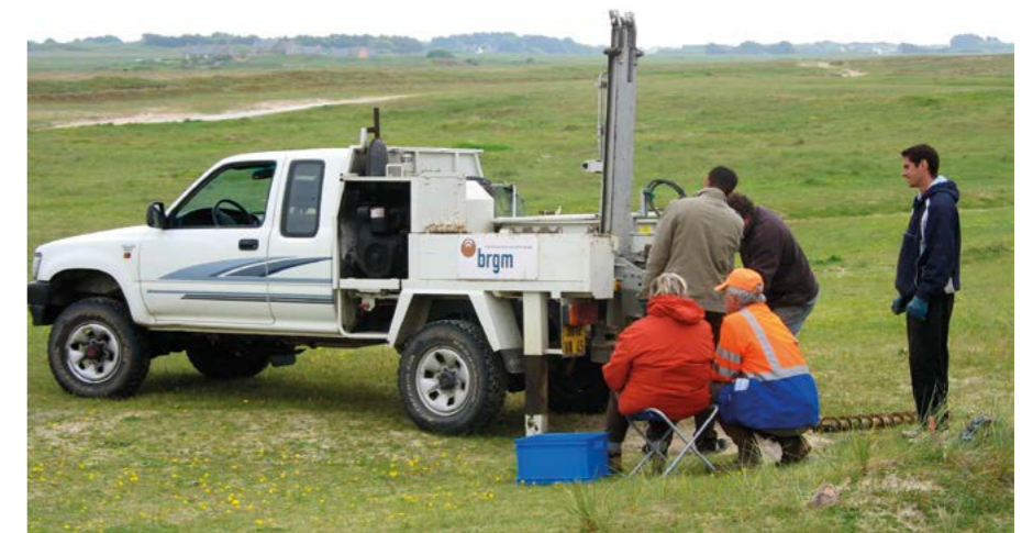
Figure 12 : tarière mécanique sur véhicule tout terrain : sondage dans les formations dunaires de la pointe de la Torche et de Pors-Carn. (Source : Alain Hénaff, 2009)
