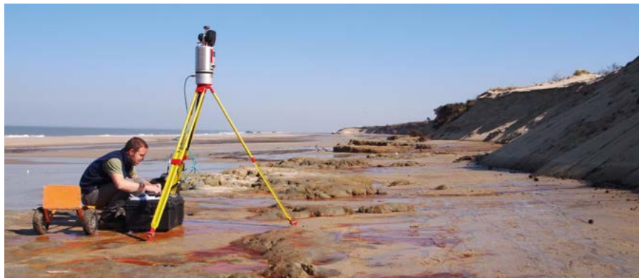
Figure 11 : scanner laser terrestre, plage de l'Amélie, Soulac-sur-Mer, 2014. (Source : Serge Suanez)
