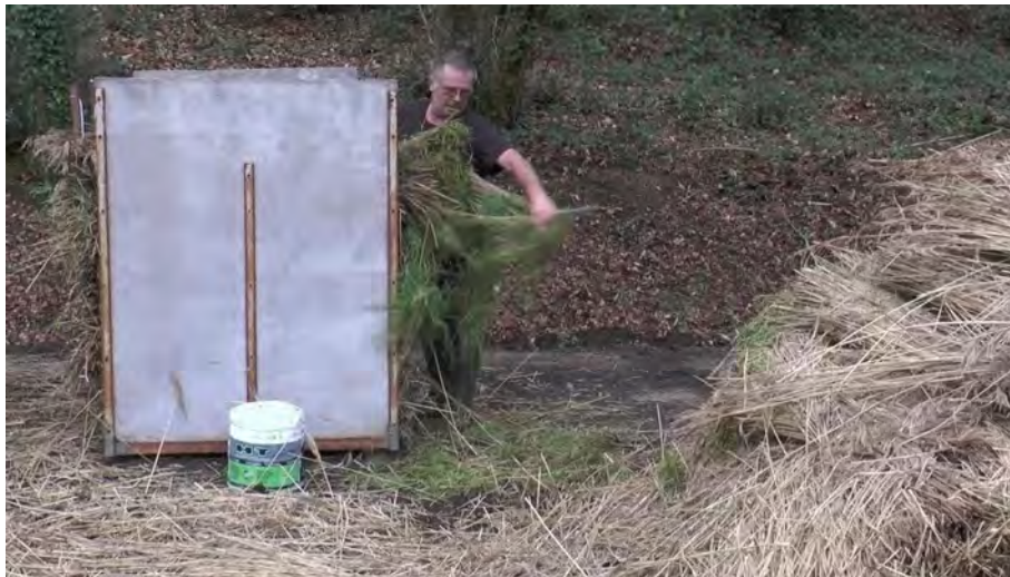
Ill. 6. Enlèvement des herbes de pied d'une gerbe de roseau. ©PNRGM. 2020
